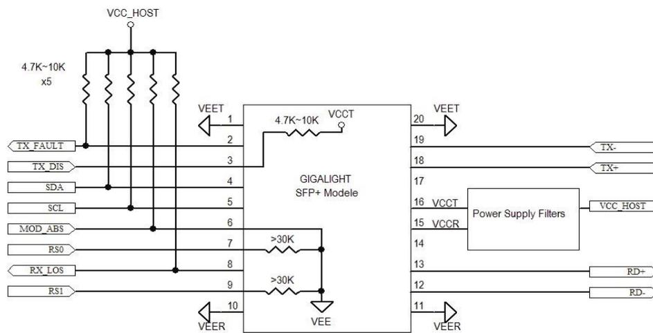
Figure 4. Host-Module Interface
