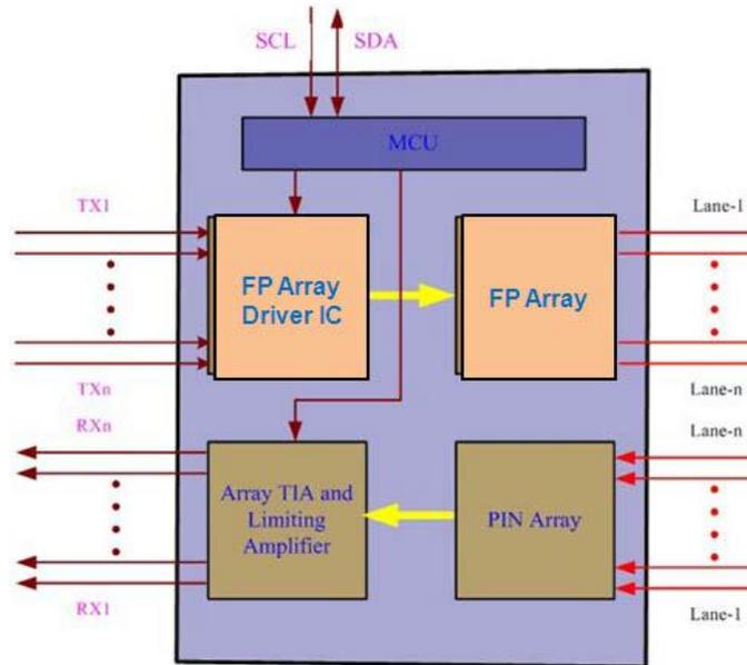
**Figure I. Module Block Diagram**
