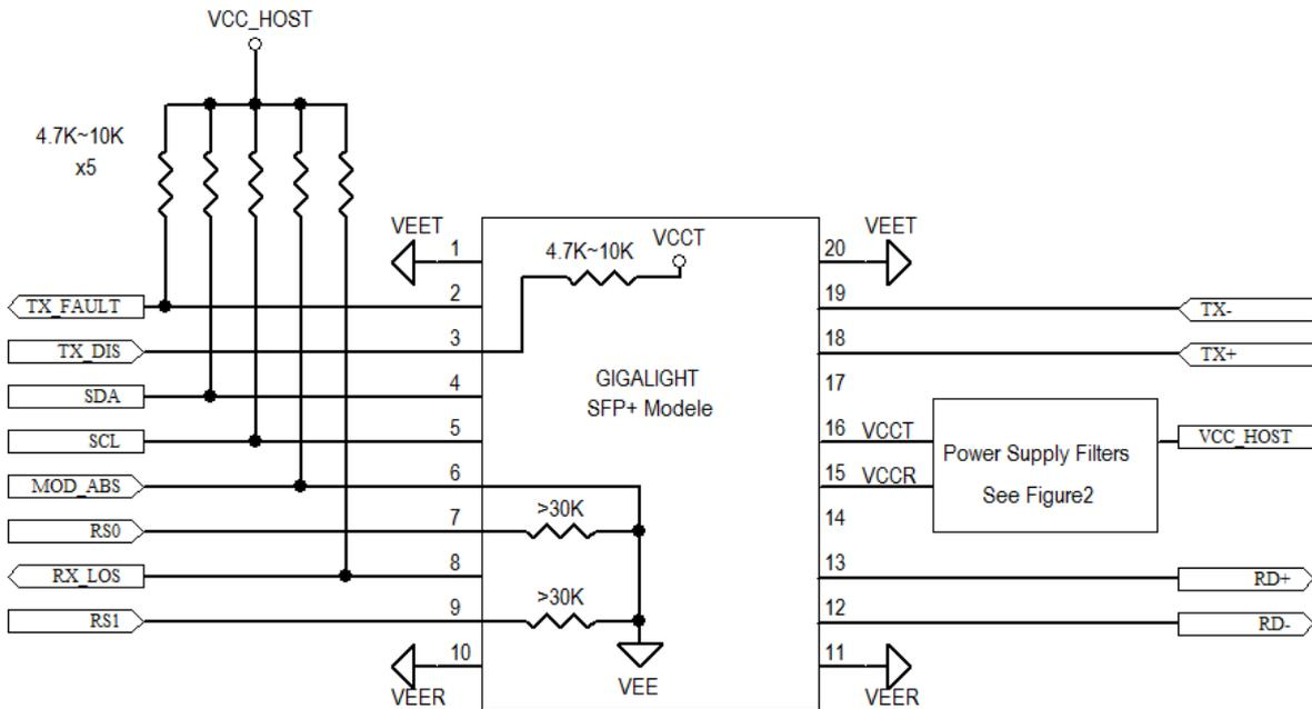
Figure 4. Host-Module Interface
